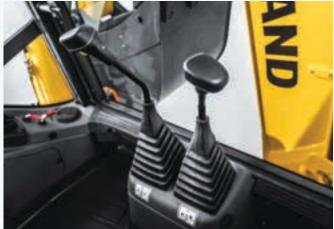
• Controlos piloto convencionais para a retroescavadora fornecem boa resposta e retorno do sistema hidráulico
