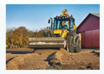
Uma bomba hidráulica de cilindrada variável só fornece caudal a pedido, poupando combustível durante a circulação em estrada e em aplicações tais como nivelamento e terraplenagem
