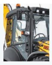
Uma montagem em pilar do tubo de escape para uma vista desafogada da carregadora
