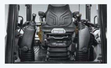
As torres dos joysticks da retroescavadora ajustam-se em todas as direções para a posição mais confortável
